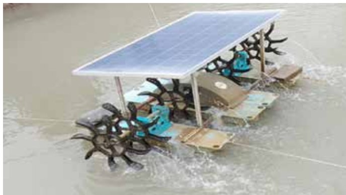
▲ 2) ดำเนินการติดตั้งกังหันตีน้ำเติมอากาศเพื่อป้องกันน้ำนิ่งในบ่อน้ำนอกพื้นที่โรงงานเกิดกลิ่นเหม็นและมลพิษทางน้ำและอากาศ
